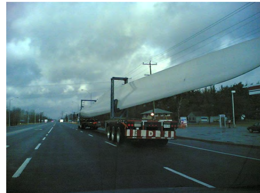
Photo 50 : Camion de transport des pales d'une éolienne
