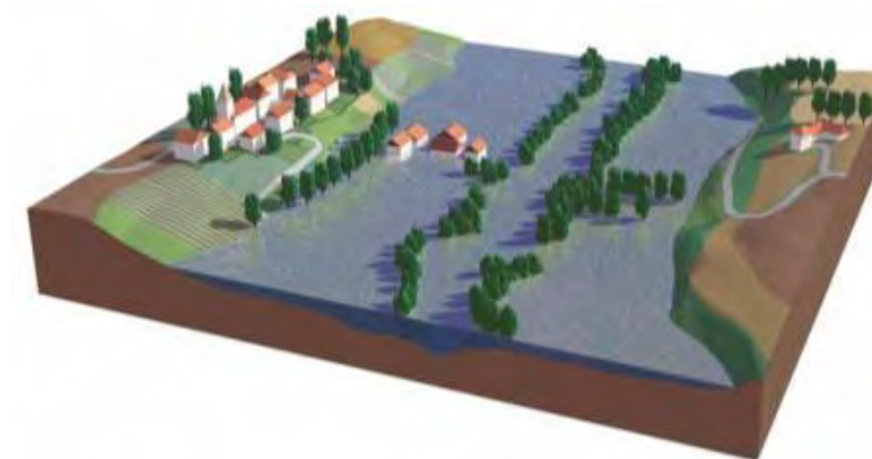
Figure 32 : Schéma de principe d'une inondation liée à la montée des eaux en région de plaine
