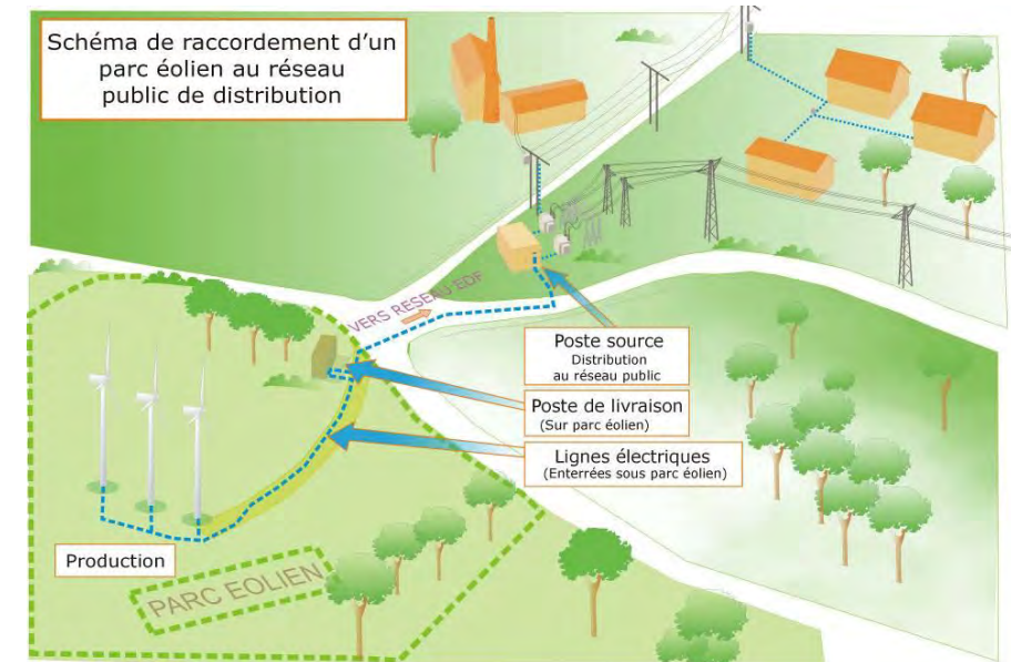
Figure 11 : Composants du parc éolien
